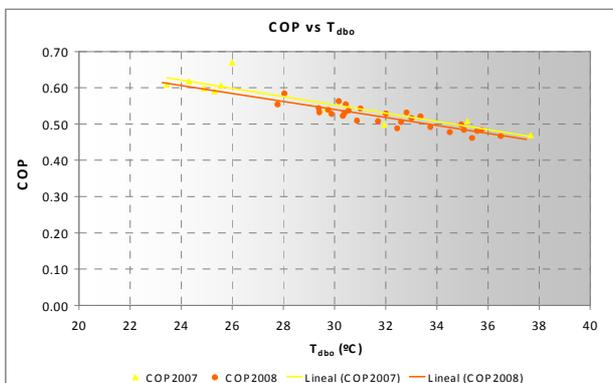
Fig. 4. COP vs  $T_{dbo}$
