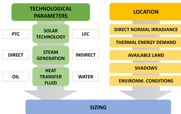
Fig. 1. Main design parameters
